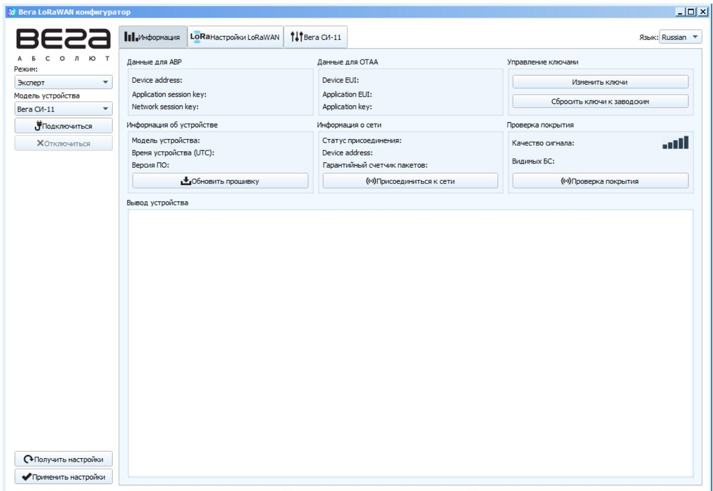
Меню слева позволяет переключаться между режимами работы программы «Простой» и «Эксперт», выбирать модель устройства, осуществлять подключение к устройству или отключиться от него, получать и применять настройки.
