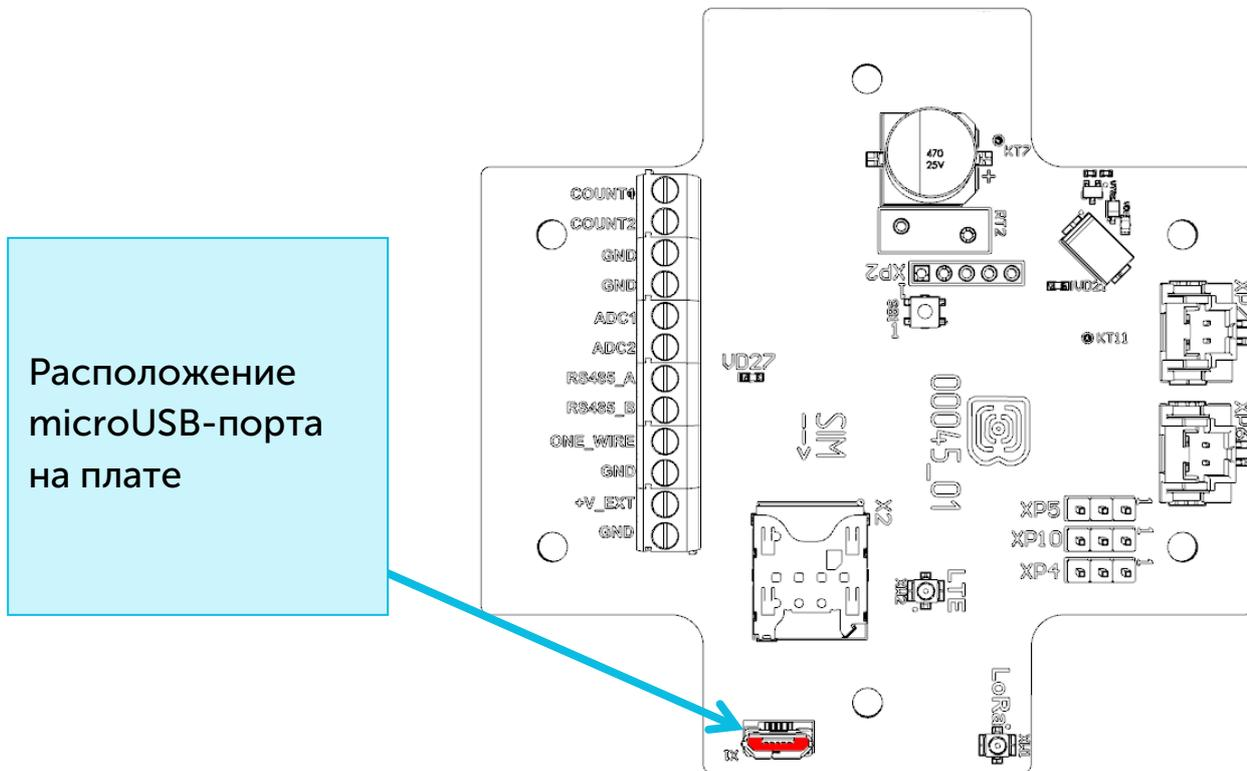
Перед первым подключением устройства к компьютеру необходимо установить драйвер для COM-порта **stsw-stm32102**, который можно скачать на сайте [iotvega.com](http://iotvega.com).
