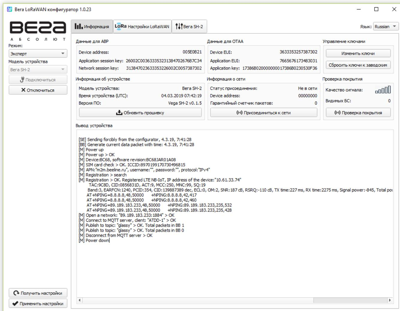
Для считывания настроек с устройства нужно нажать кнопку «Получить настройки», до этого момента в программе будут отображаться настройки по умолчанию или с последнего подключенного устройства.
