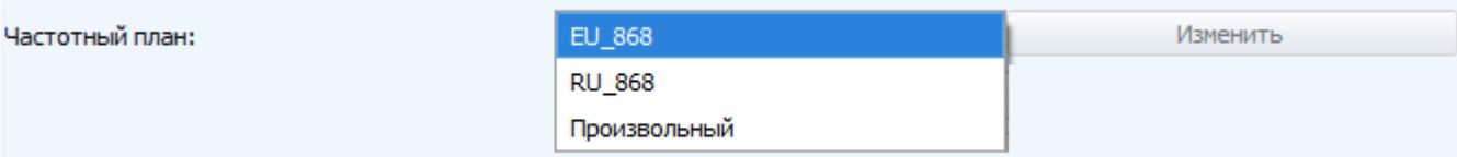
Модем поддерживает следующие частотные планы:
